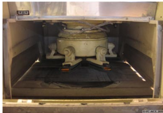
Figura 2 Portamuelas del cabezal de pulido
