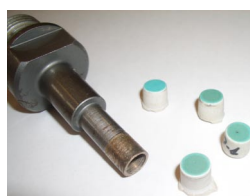
Figura 2. Muestras y broca de 6 mm para la obtención de muestras de superficies cerámicas
