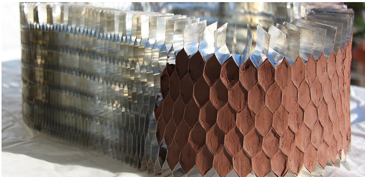
Fig. 1.25 | Test Material del Sistema. Malla NEX + Piezas Cerámicas
