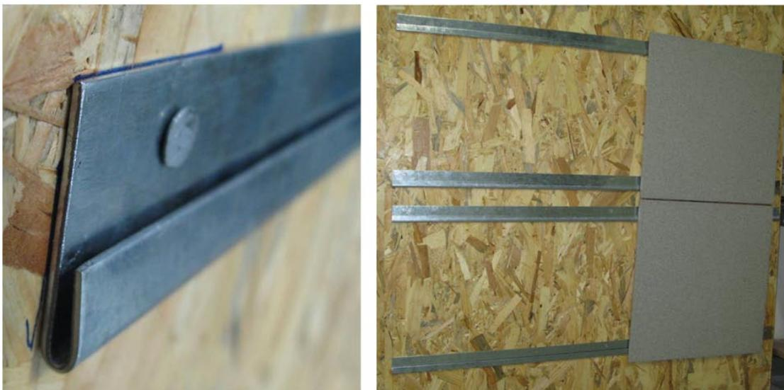
Figura 9. Prototipo del sistema por rastreles independientes
