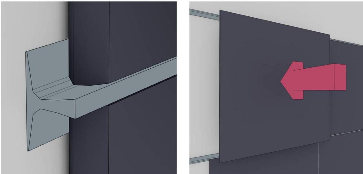
Figura 10. Esquema de montaje del sistema por juntas rígidas
