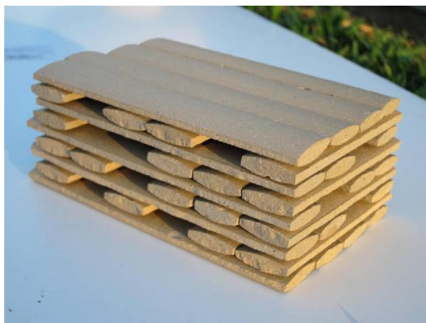
Módulo básico de la celosía. Primer sistema
