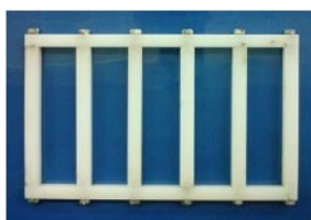
Figura 1. Molde utilizado en el encofrado
