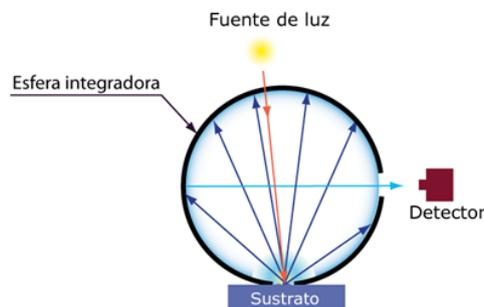
*Figura 3. Esquema de una esfera integradora para medidas de reflectancia difusa con geometría 8°/d. La luz entra en la esfera integradora formando un ángulo de 8° respecto a la vertical del sustrato a medir. La luz difundida por este sustrato es colectada en el interior de la esfera, donde posee un recubrimiento blanco altamente reflectante. Tras múltiples reflexiones la luz sale de la esfera hasta que llega al detector.*
