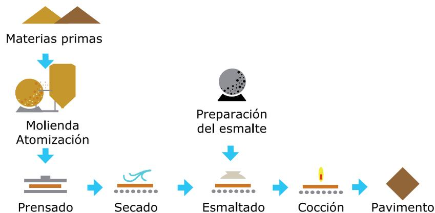
Figura 1. Proceso de fabricación de baldosas cerámicas.
