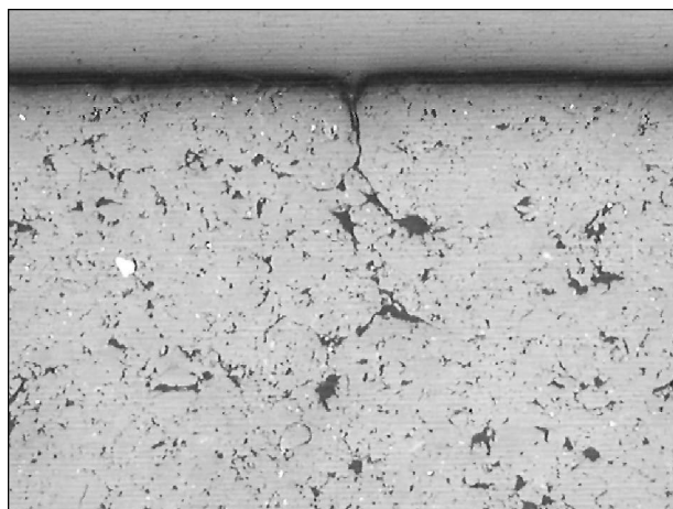
Figura 10. Sección transversal de la muestra GR a 1160°C.
