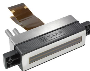
Figura 4. Ejemplo de un cabezal de impresión piezoeléctrico industrial DOD con 1000 boquillas y una anchura de impresión de 70 mm (Xaar plc, Reino Unido).
