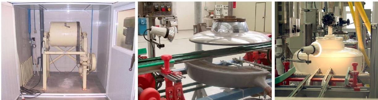
Figura 6. Fotografía del molino utilizado para la realización de las pruebas y de la campana utilizada en la realización de las pruebas, previamente y durante el proceso de esmaltado.
