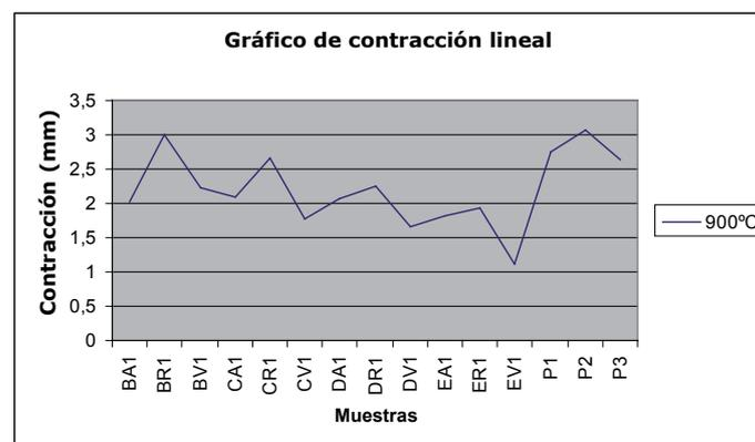
Gráfico 3. Contracción lineal de las muestras sinterizadas a 900°C, durante 1 hora.
