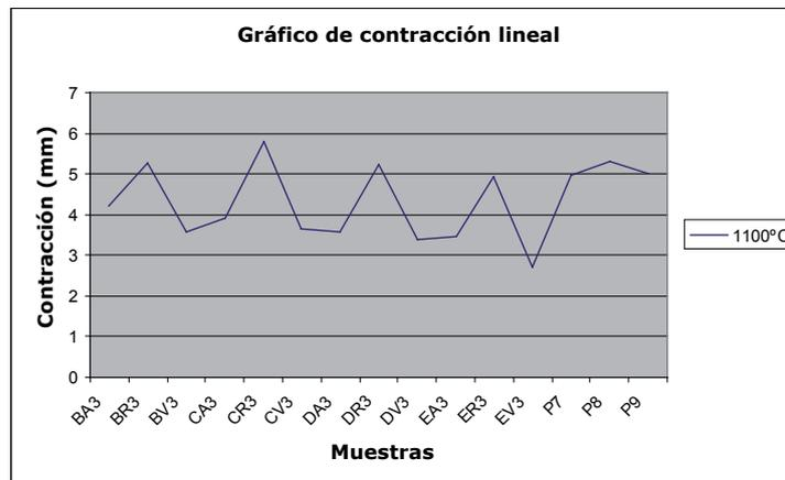
Gráfico 5. Contracción lineal de las muestras sinterizadas a 1100°C, durante 1 hora.
