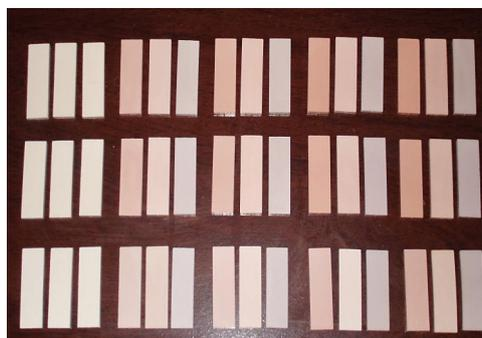
a) Sinterización a 900°C, b) sinterización a 1000°C, c) sinterización a 1100°C.
