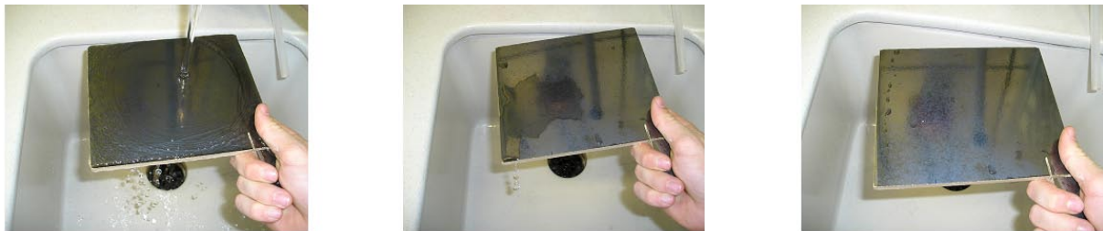
Figura 4. Ensayo en el que baldosa con aspecto metalizado muestra hidrofobicidad.
