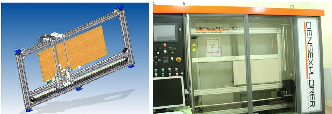
Figura 2. Bastidor interno y vista general del instrumento de medida de la densidad aparente.
