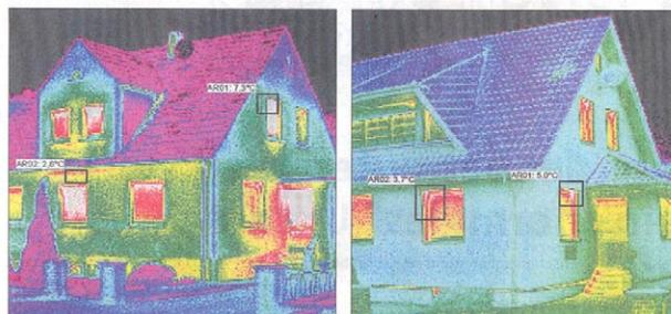
Figura 2. Fotografías termográficas de una casa antes y después de su rehabilitación.
