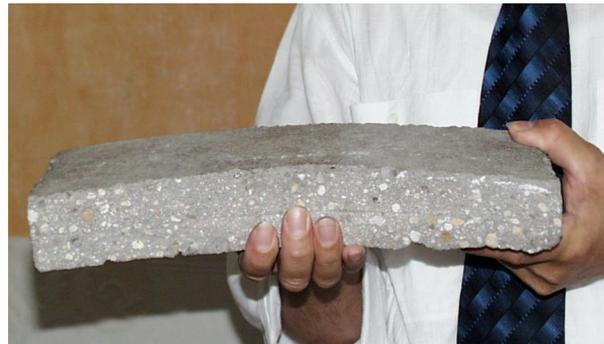
Figura 4. Los recrecidos flotantes sufren movimientos por retracción importantes durante su proceso de fraguado.
