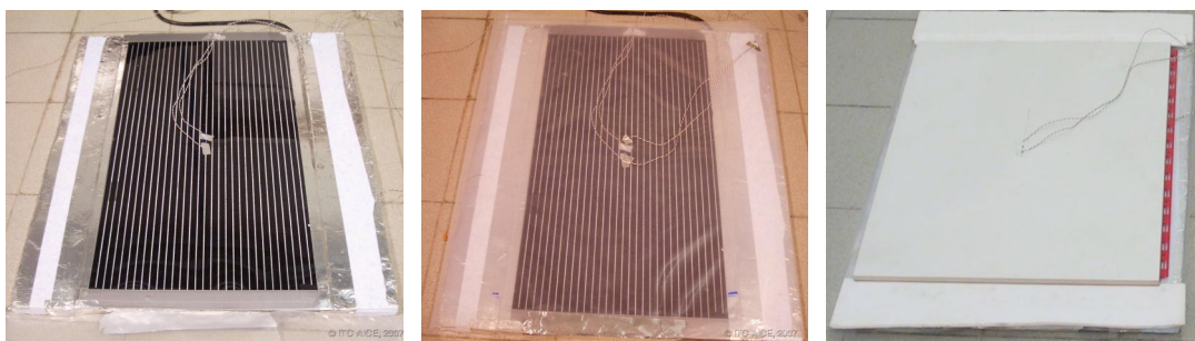
Figura 3. Fotos mostrando la colocación de los termopares de medida sobre el elemento calefactor (izquierda), el sustrato de polietileno (centro) y la pieza (derecha).
