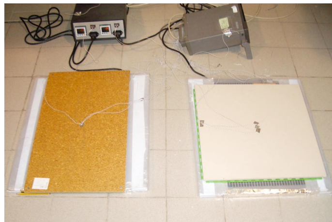
Figura 5. Foto general del montaje mostrando la diferencia de dimensiones entre la pieza de corcho y del sistema CT.
