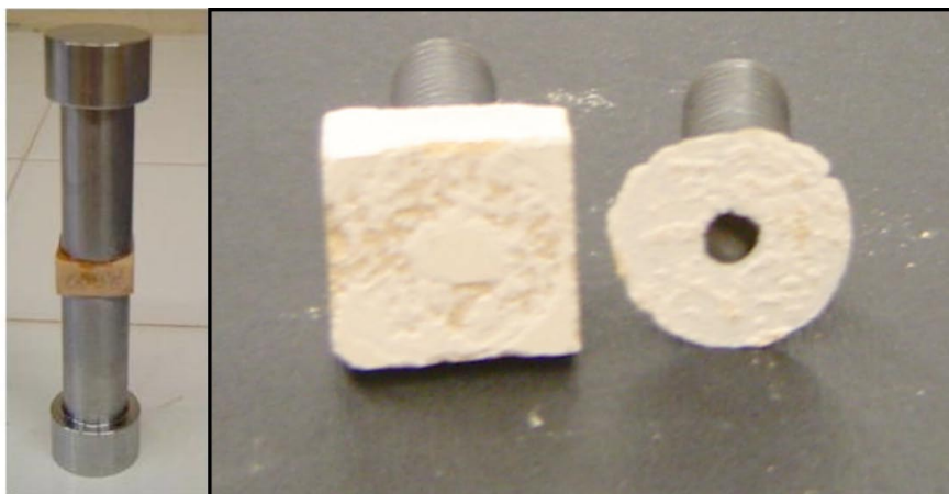
Figura 1. Conjuntos de muestras cerámicas (engobe + soporte) con las piezas metálicas, izquierda, y las interfases de fractura después del ensayo mecánico.
