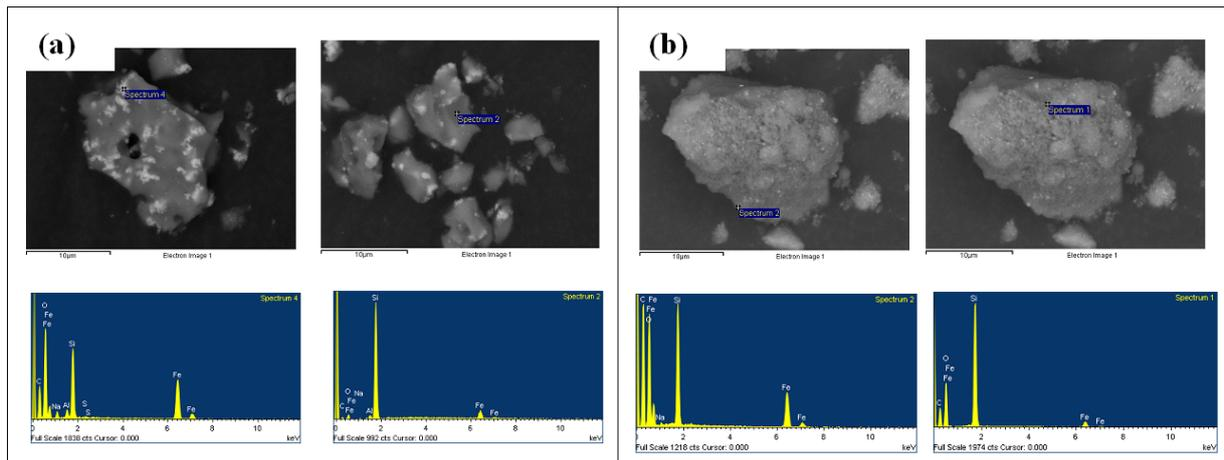
Figura 1. Micrografías SEM de las muestras: (a) 0,1Fe-Q-5%KNO<sub>3</sub> 100°C/12h, (b) muestra coloidal COL1.
