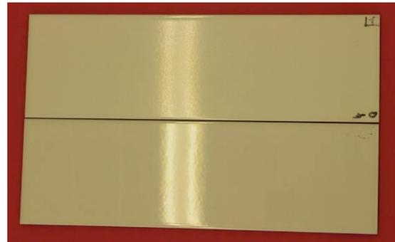
Figura 3. Piezas previa (abajo) y posteriormente (arriba) a la aplicación de óxido de aluminio nanométrico.
