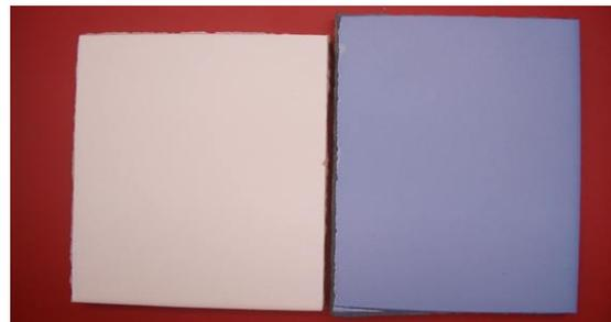
Figura 4. Piezas previa (izquierda) y posteriormente (derecha) a la aplicación de un color soluble.
