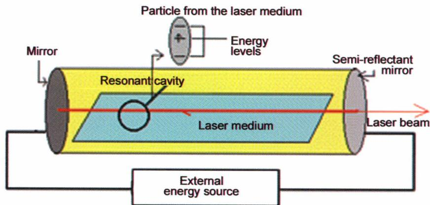
Figure 1. Laser parts<sup>[3]</sup>.
