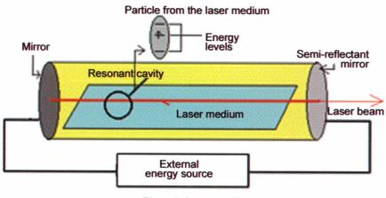
Figure 1. Laser parts<sup>[3]</sup>.
