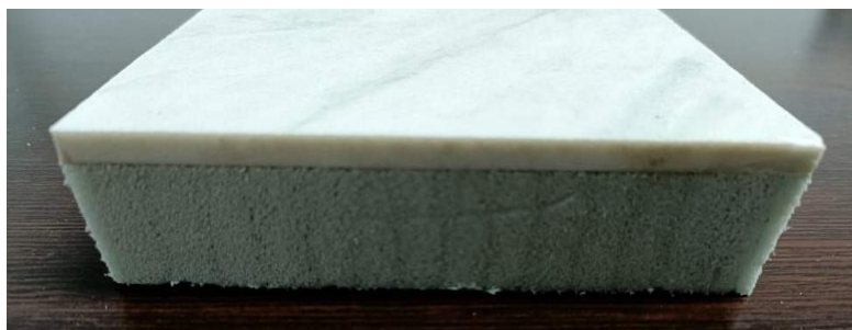
Figura 01. Foto del sándwich cerámico, con el nuevo núcleo estructural reciclado.
