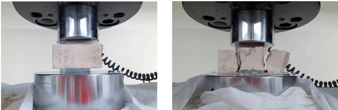
**Figura 3:** Izquierda: Montaje experimental; Derecha: Probeta rota
