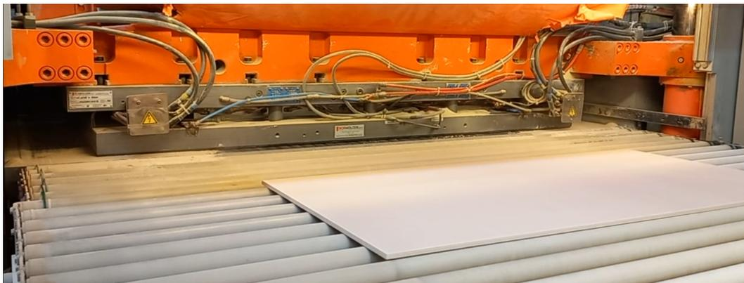
**Figura 16** – Baldosa prensada de 600x1200 mm
