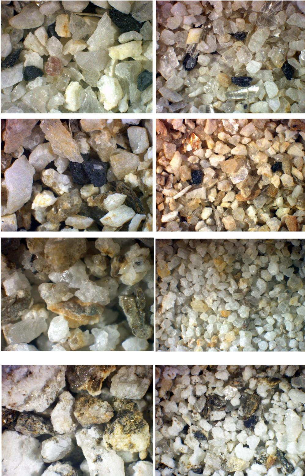
**Fig 4a-h.** Imágenes obtenidas con un microscopio binocular de materiales tamizados de diferentes tamaños (las imágenes de la izquierda muestran los tamaños de grano de + 1 mm; las imágenes de la derecha muestran los tamaños de grano de -1 mm a +500 $\mu$ m (a, b: FLD KR, c, d: FLD-H, e, f: FLD-K, g, h: FLD-CE).
