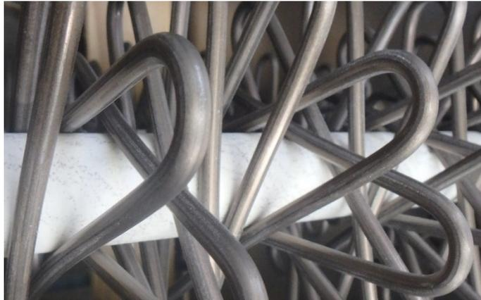
**Fig. 8** – Detalle de las resistencias que componen el calentador eléctrico
