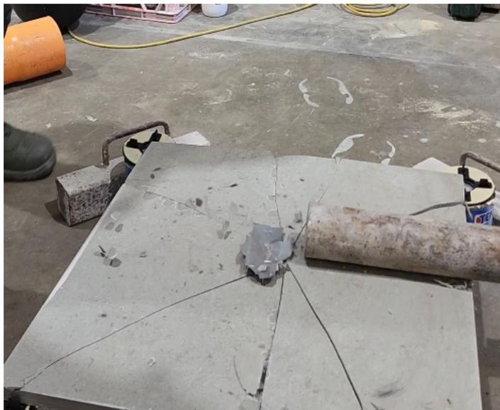
**Foto 5.** Baldosa sobre pedestales fracturada, reforzada con una malla de fibra de vidrio adherida con adhesivo cementoso. La carga utilizada para romper la baldosa fue un peso de acero de 10 kg y 60 mm de diámetro.
