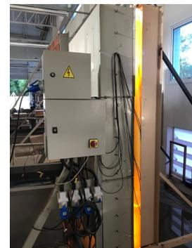
**Figura 8-** Cámara de choque térmico con los prototipos.
