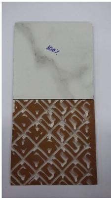
Baldosa sin simulación de fallo de asentamiento – 100% de relleno debajo de la baldosa
