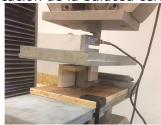
Ensayo de cizalladura por compresión
