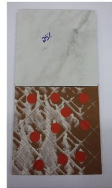
Baldosa con simulación de fallo de asiento del 25% – 75% de relleno debajo de la baldosa
