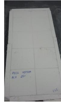
Prototipo con recubrimiento de baldosas de gres porcelánico y mortero ACIII con un 25% de fallo de asiento y con material de rejuntado elastomérico – con restricción
