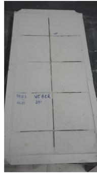
Prototipo con recubrimiento de baldosas de gres porcelánico y mortero ACIII con un 25% de fallo de asiento y con material de rejuntado elastomérico
