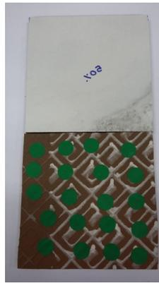
Baldosa con simulación de fallo de asiento del 50% – 50% de relleno debajo de la baldosa
