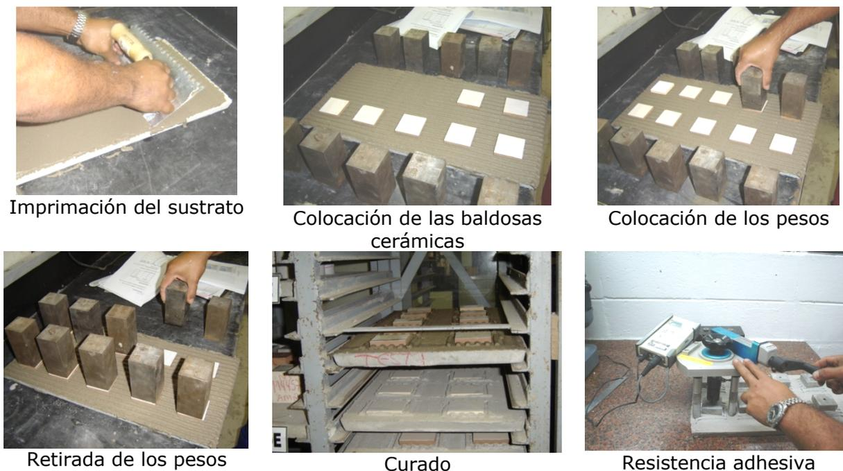
**Figura 4** – Procedimiento para la realización del ensayo de adhesión y tiempo abierto.
