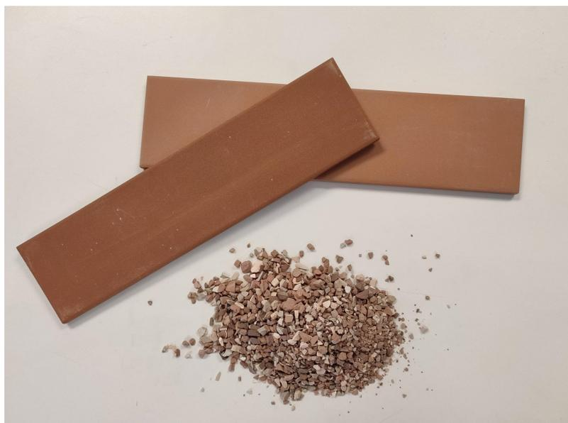
**Figura 2.** Soportes cerámicos fabricados incorporando un 40% de tiesto en la composición
