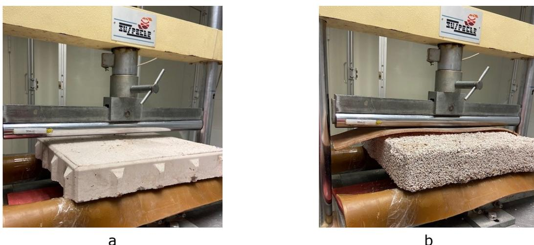
**Figura 8.** Determinación de resistencia a flexión de las baldosas desarrolladas en empresa: a) Compacta; b) Porosa.
