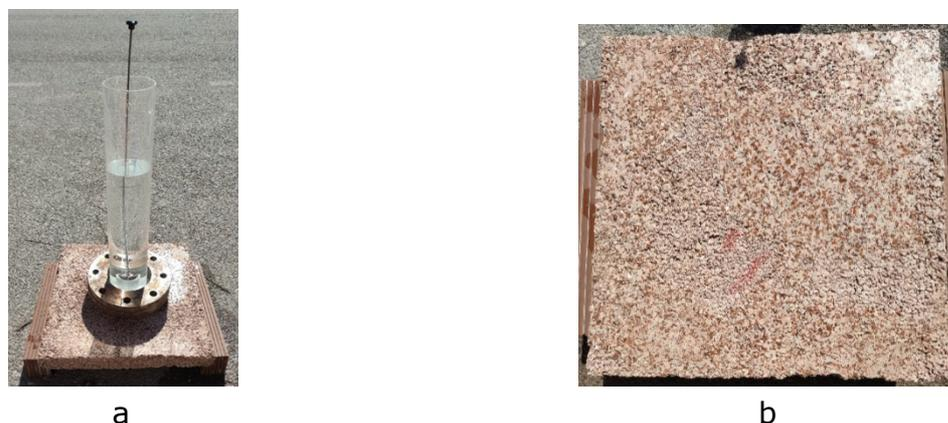
**Figura 4.** Determinación de permeabilidad en las piezas porosas; a) Ensayo permeabilidad; b) Cara desbastada de la pieza porosa
