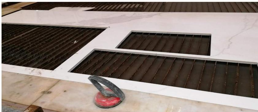
**Figura 16.** Foto de sándwich cerámico cortado con wáter jet de cinco ejes.
