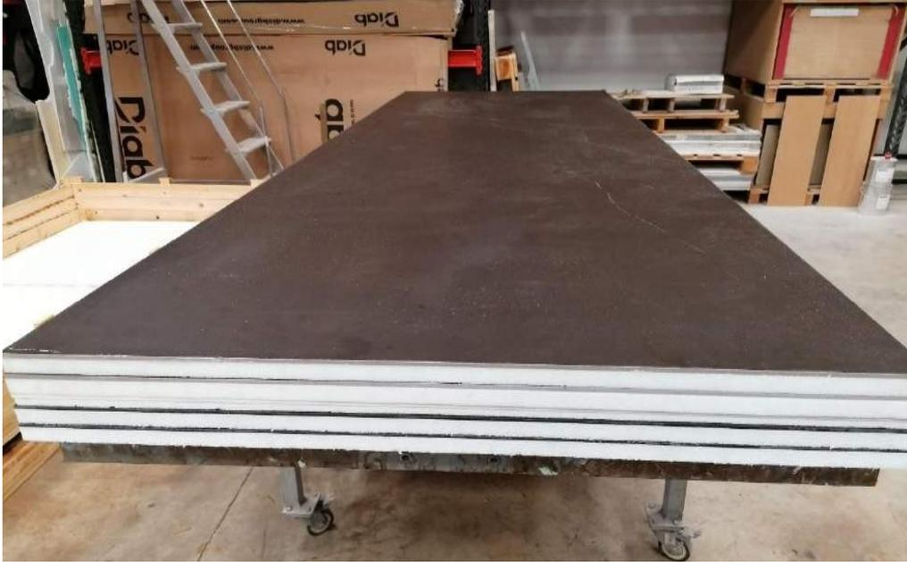
**Figura 14.** Fotos láminas de sándwich cerámico, para revestimiento de obra seca.
