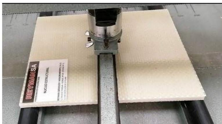
**Figura 10.** Foto ensayo flexión del sándwich técnico.
