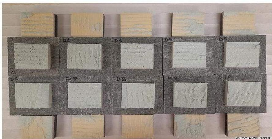
**Figura 09.** Foto de las probetas del ensayo de resistencia a la adhesión.
