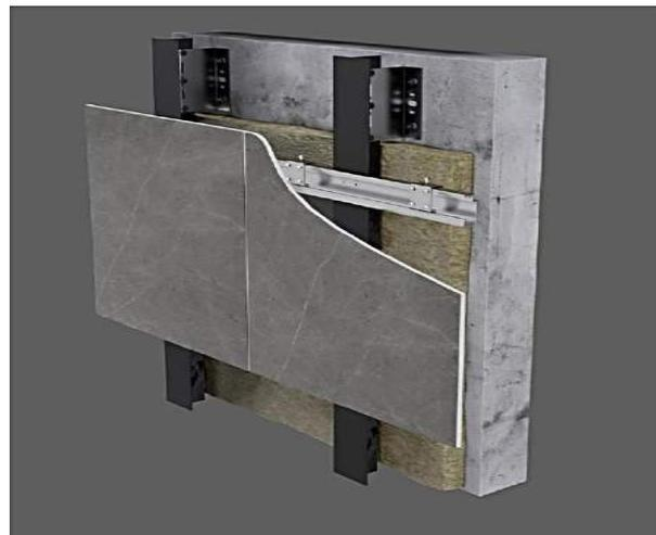
**Figura 22.** Fachada multicapa.
