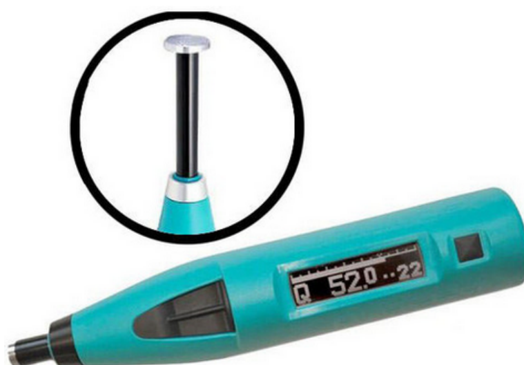
Figura 5. Un Martillo de Schmidt de "bajo impacto" con capuchón (indicada) para probar superficies más delgadas y quebradizas, como las baldosas cerámicas. (NOTA: algunas superficies, como la cerámica delgada o mosaicos, aún pueden ser dañadas con el capuchón).
