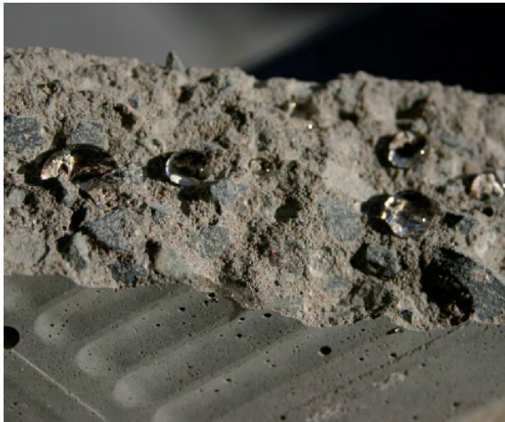
Foto 3. Hormigón tratado con un sellante basado en la nanotecnología repele el agua. Se desconoce la eficacia con morteros friables. 2
